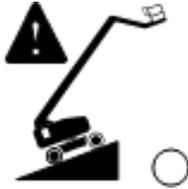
A lâmpada indicadora de inclinação de máquina está acesa: a lâmpada está acesa e o alarme de inclinação soa quando a máquina excede as configurações de ativação do sensor de inclinação. Siga o procedimento adequado abaixo e mova a máquina até uma superfície firme e nivelada.
