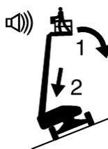
Se o alarme de inclinação soar com a plataforma em aclive:
