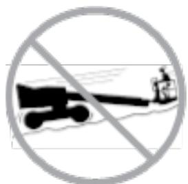
Limite a velocidade do percurso de acordo com as condições da superfície, de congestionamento, inclinação, localização de pessoas e quaisquer outros fatores que possam causar colisões.
