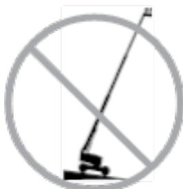
Não dependa do alarme de inclinação como um indicador de nível. O alarme de inclinação soará na plataforma somente quando a máquina estiver em declive acentuado.
